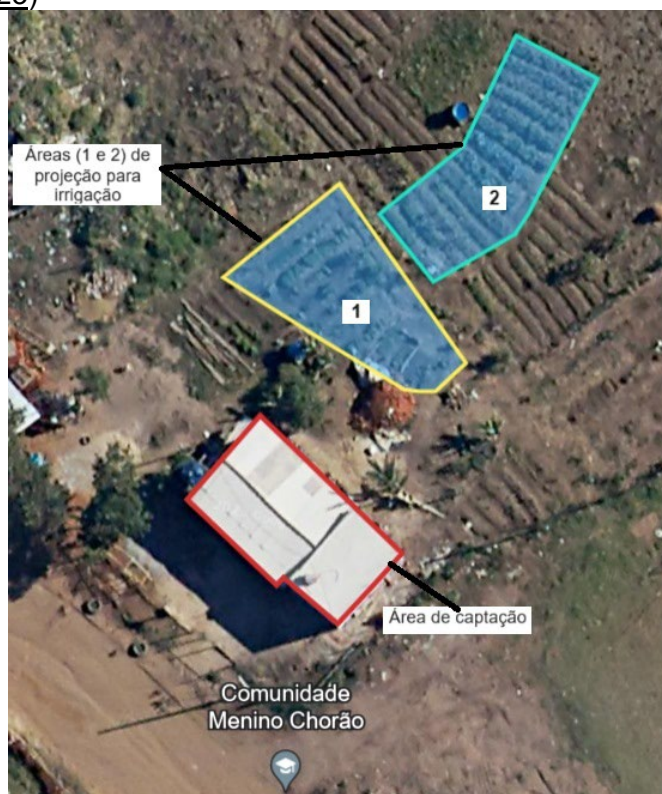
Figura 4. Projeções das possíveis áreas de irrigação (1 e 2) e área de captação de águas pluviais (Google Earth, 2023)
