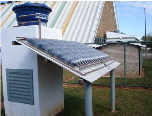
Figura 3. Aquecedor solar instalado no chão, na área experimental do Laboratório de Conforto Ambiental para exposição.
