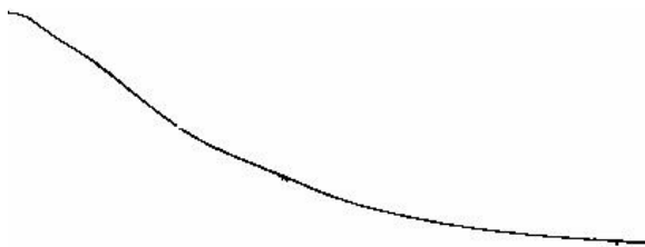
Figura 8. Registro gráfico de um amortecimento supercrítico observando-se a condição \frac{\gamma}{2} > \omega_0
