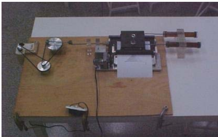
Figura 5. Apresentação do sistema completo, com o oscilador e registrador x-t ao centro e tendo à esquerda o propulsor externo para estudo de oscilações sob ação de forças externas, e à direita, os dois amortecedores cilíndricos associados em paralelo para estudo de amortecimento monitorado.
