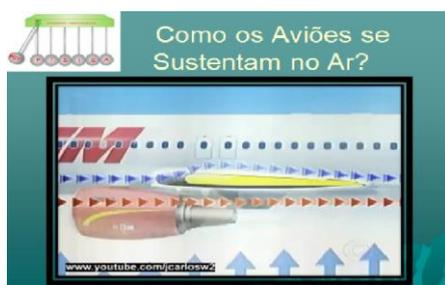
**Figura 1.** Representa o vídeo que demonstra a sustentação do avião no ar a partir da diferença de pressão e velocidade do ar perpassando as diferentes partes da asa. (Palestra: 'Física Aplicada Às Aeronaves').
